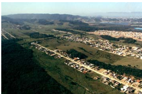
Foto 24 – Loteamentos desconectados (sem integração viária)
